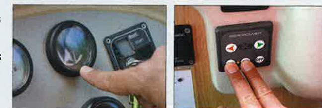
L'indicateur de barre (à g.) et le propulseur (à dr.) permettent de manœuvrer.
