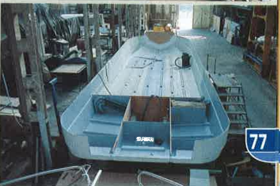
Quelques stades de la construction des bateaux: le bureau d'études, un rouf dans son moule en cours de stratification, une coque prête à recevoir les aménagements.
